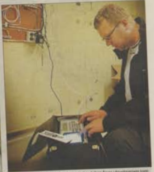
SNABT OCH EXAKT. I den stora svarta väskan finns sändningskort som mottar tv-signalerna och får dem att komma på rätt frekvens. Själva arbetet tar knappt en minut för serviceteknikern Manfred Johansson.
